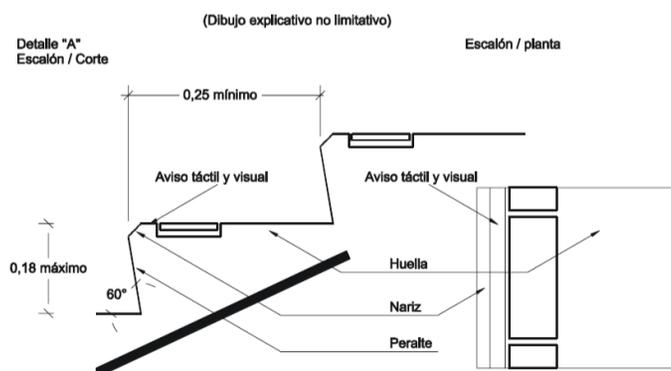
c) La altura de colocación debe ser de entre 0,80 m y 0,90 m medidos a partir de la nariz del escalón hasta el plano superior del pasamano.
